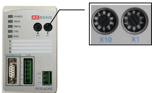
图 2-10 PROFIBUS 从站地址设置开关 SA，地址设为 19
